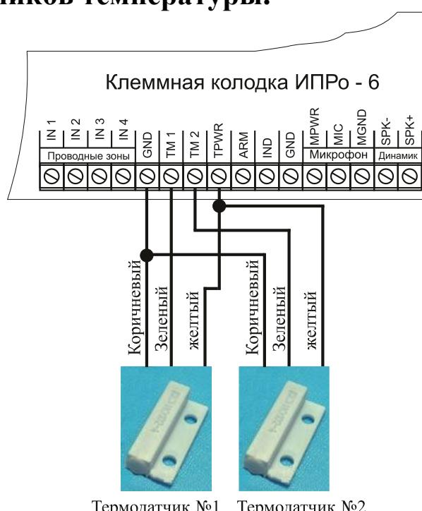
Подключения 2-х датчиков
