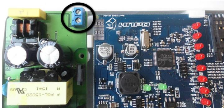
Если питание не подключено, необходимо подключить. Для этого необходимо к клемной колодке блока питания (справа вверху) подключить провода. Для удобства монтажа, плату Прибора можно снять.
