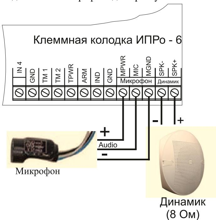
Для работы в составе системы используются специализированные микрофоны, имеющие встроенный усилитель и допускающие подключение с помощью длинных проводов (**до 100 метров**).
