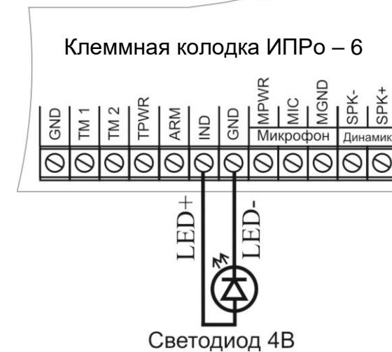
Внешний световой извещатель. В данном режиме работы Выход «IND» является выходом «-12В» (ток до 500mA). Чтобы активировать данный режим работы нужно выбрать пункт «Внешн.известатель».
