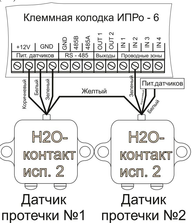
Подключение 2-х датчиков
