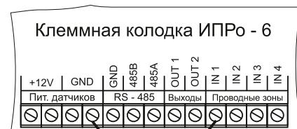
Подключение 2-х датчиков
