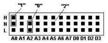
12 рядов перемычек разделены на 2 сектора A0...A7 и D0...D3. Для программирования датчика необходимо выставить перемычки в зоне "A" в и В зоне "D" в произвольном порядке, для обеспечения уникального кода датчика.
