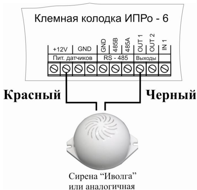
Подключение сирены с током потребления до 1А
