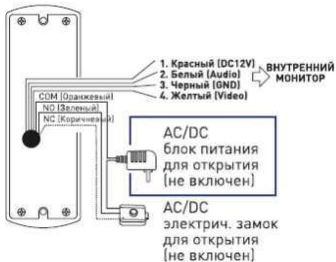
**Примечание:** данная панель имеет возможность подключения как электромеханического замка с (N.O) контактами так и возможность подключения электромагнитного замка с (N.C) контактами
